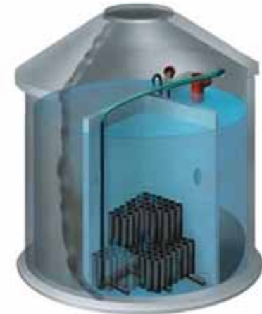
Bild 3: Schema einer Festbettanlage [ZAPF GmbH]
