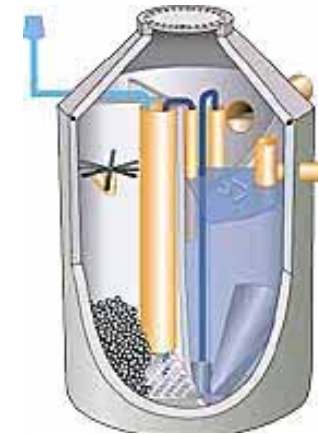
Bild 6: Schema einer Tropfkörperanlage [MALL GmbH]
