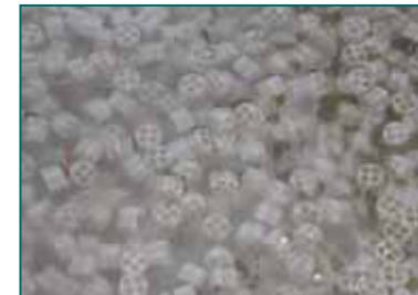
Bild 5: Aufwuchskörper in der Kläranlage Hesperange des Forschungsprojekts LITFLUID vom CRTE
